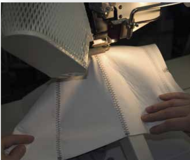
Gore-Tex-Membrane für wasserdichte Stiefel wird verschweißt. Dabei wird auf sämtliche Nahtstellen des mehrlagigen Innenfutters bei rund 360 Grad ein schmaler Dichtstreifen aufgebracht.
