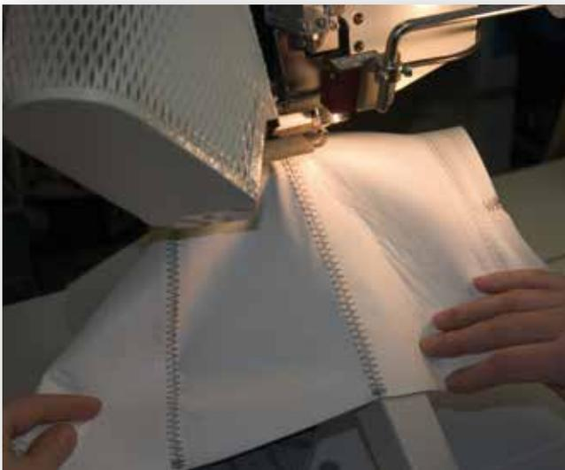
Gore-Tex-Membrane für wasserdichte Stiefel wird verschweißt. Dabei wird auf sämtliche Nahtstellen des mehrlagigen Innenfutters bei rund 360 Grad ein schmaler Dichtstreifen aufgebracht.
